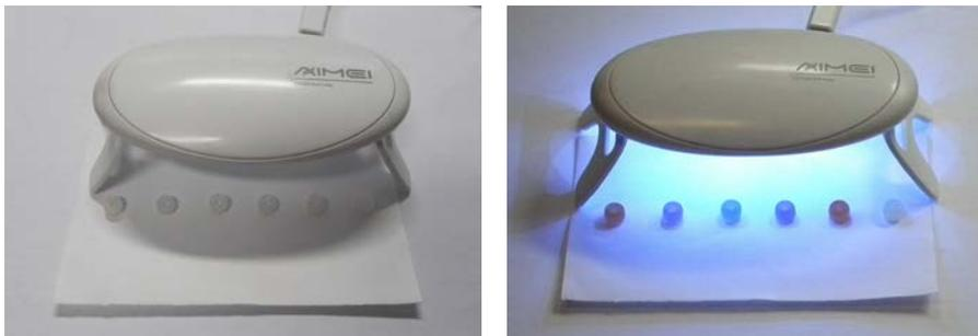
Abb. 2: Qualitativer Nachweis von UV-Strahlung durch UV-Perlen, die von einem im UV-Bereich strahlenden Nagellack-härter angeregt werden.
