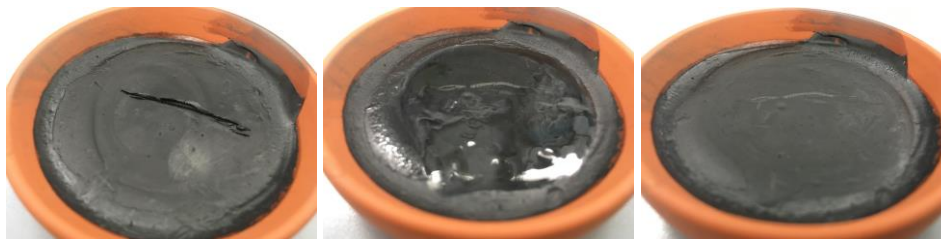
Abb. 2: Modellexperiment zum selbstheilenden Asphalt nach Beschädigung (links), nach 10 s in der Mikrowelle (mittig) und nach Aushärten (rechts).
