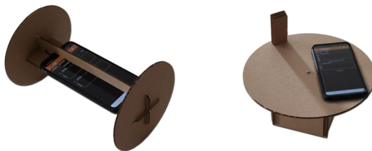
Abb. 1: Aufbau der Rolle (links) und der Salatschleuder (rechts)
